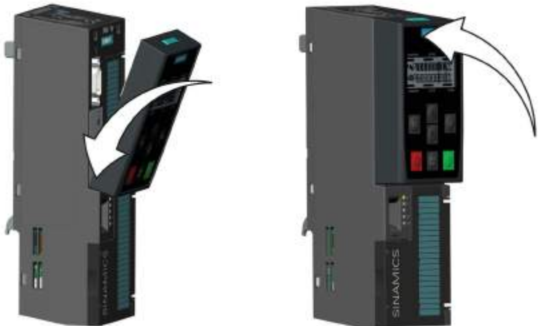
Figura 5-1 Instalación del BOP-2 en la Control Unit
